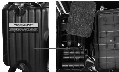
Рис.9 Обслуживание воздушного фильтра
